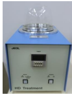
112：親水化处理装置
